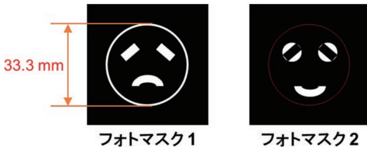
図2 作製パターン1におけるフォトマスクの形状
