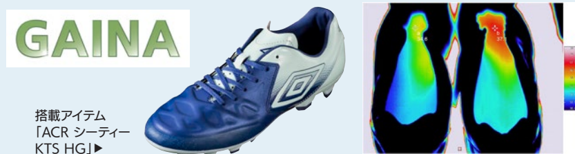
▲サーモグラフィによる熱侵入量の違い。 左が「GAINA」搭載スパイク、右は従来品
