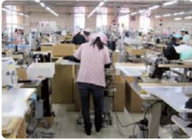
村岡工場・西都工場にある「一枚流し立ちミシン」。右手前→奥→左手前と、逆U字ラインで縫っていく(西都工場)
